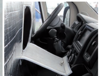
Zugangsklappe mit Halteknopf und Magnetverschluss.
