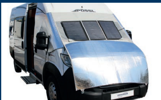
Solarmodul MT Basic Travel Line BT- SM 120 montiert.
